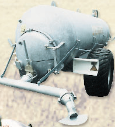
Rampe d'épandage ▲ avec pendillards et turbine de répartition
