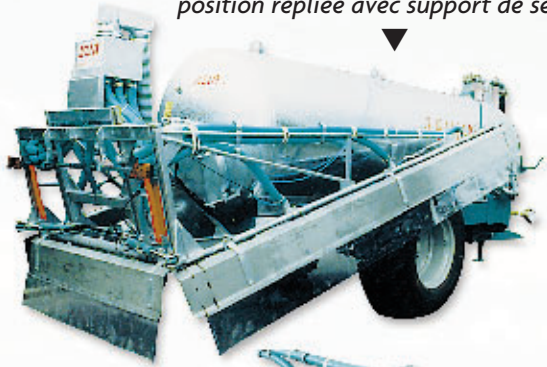
Rampe d'épandage avec déflecteur inox en position repliée avec support de sécurité
