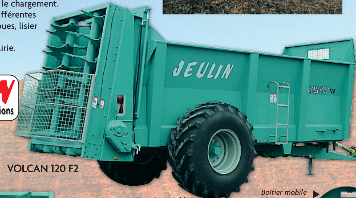
Hérissons verticaux avec dents démontables (rotation 420 trs/mn) Boîtier renvoi d'angle à bain d'huile de forte puissance
