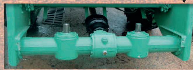
Accouplement du boîtier hérisson avec un cardan à roue libre
